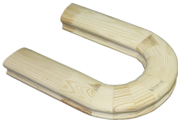
Поворот поручня Сосна 180 град АА сращенный под 60 балясину. поручень 48*75 мм
